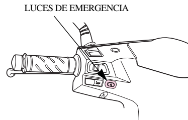
LUCES DE EMERGENCIA
