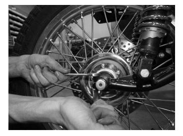
**Step 3** Loosen the axle pinch bolt.
