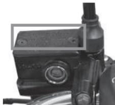
Imagen 28. Nivel del líquido de frenos
