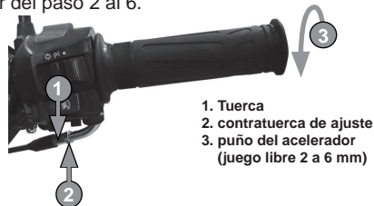
imagen 25. ajuste del puño del acelerador.
