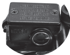
Imagen 32. Completar el nivel de líquido del freno delantero
