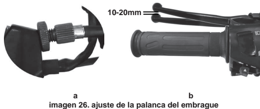
imagen 26. ajuste de la palanca del embrague
