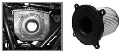
Imagen 6. Filtro de aire.
