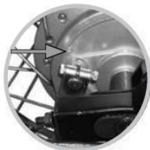
Imagen 28. Indicador de desgaste de freno trasero
