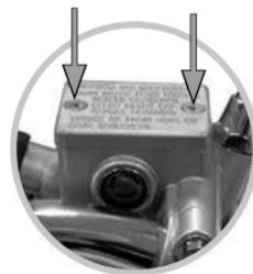
Imagen 31. Completar el nivel de líquido de freno delantero
