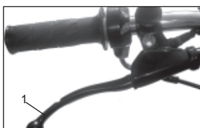
1. Front brake lever अगली ब्रेक का लीवर
