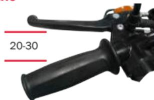
1. Mida la distancia que separa la palanca del freno trasero antes de que comience a engranar. La libre ejecución de la palanca del freno trasero deberá ser 20 – 30 mm.
