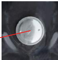
Tapa tanque de combustible
