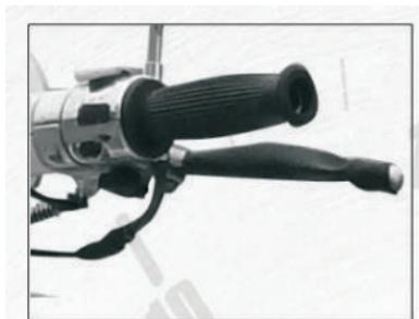
Controle el desgaste del freno delantero. Si el recorrido de la empuñadura de freno delantero es muy grande, esto indica que el desgaste de la zapata de freno delantera esta ya más allá del límite.
