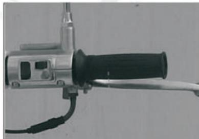
Compruebe si la empuñadura de aceleración se vuelve flexible. Si no, es necesario limpiar el acelerador o cambiar el cable de acero.
