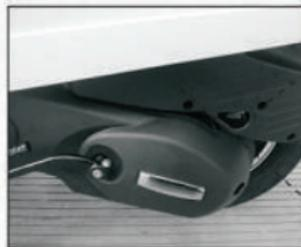
Retire los tornillos de fijación de la tapa del filtro de aire y retire la tapa del filtro de aire. Compruebe si hay demasiado polvo en la espuma de la esponja del filtro. Retire la espuma de la esponja.
