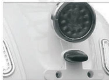
Compruebe el correcto funcionamiento del farol trasero y las luces de freno.
