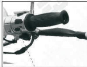
Presione el pulsador eléctrico de arranque con el pulgar derecho, y al mismo tiempo gire el mango de aceleración ligeramente con la mano derecha para agregar una cantidad adecuada de combustible.
