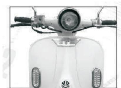
Compruebe si la luz del farol delantero, las luces de giro y los indicadores de luces funcionan correctamente.
