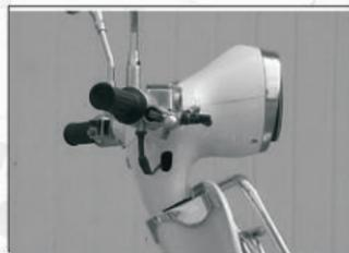
Compruebe la flexibilidad y la estabilidad del mecanismo de dirección.
