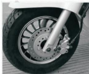
Revise la presión de aire del neumático y compruebe si la llanta se deforma. Si se encuentra alguna anomalía, debe manipularse correctamente.
