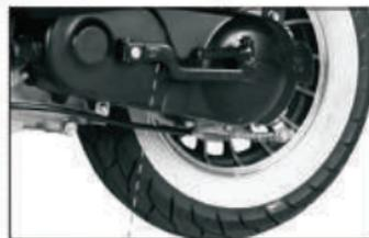
Baje con el pie el pedal de arranque hasta el límite, y suéltelo a su tiempo. El pedal de arranque debe soltarse cuando el motor este funcionando.
