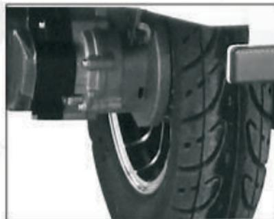
En primer lugar comprobar el desgaste de las zapatas de freno traseros. Si el recorrido del pedal de freno trasero es demasiado grande para ser ajustado, esto indica que el desgaste de la zapata del freno trasero está ya más allá del límite.
