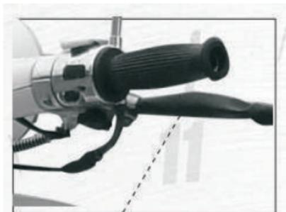
Revise el movimiento libre de la palanca de freno delantero cumple con la medida standard de 10 a 20 mm.
