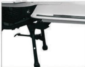
Luego coloque el sosten central, con la rueda delantera hacia arriba en caso de estacionar en una pendiente.
