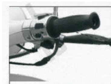
La empuñadura del acelerador debería funcionar sin problemas. La distancia de juego de la empuñadura debe oscilar entre 2 mm a 6 mm.
