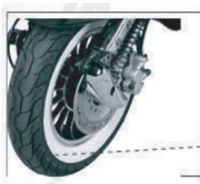
Comprobar la profundidad de desgaste de la banda de rodaje de la cubierta del neumático y si existe alguna grieta. Si se encuentra alguna anomalía, la cubierta del neumático debe ser reemplazada inmediatamente.
