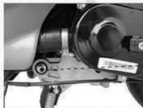
Si el aceite lubricante se vuelve negro, quite el tapón de drenaje del motor para drenar el aceite lubricante y reemplazarlo.
