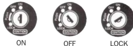
1. ON: Gire el interruptor en esta posición para encender el motor. La llave en esta posición no puede ser retirada.
