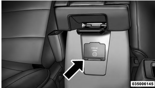
115 Volt Power Outlet
